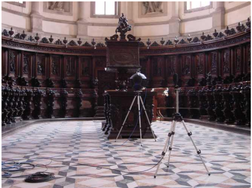
La sorgente e il ricevitore utilizzate durante le sessioni di misura nel coro della chiesa del Redentore e di San Giorgio Maggiore
